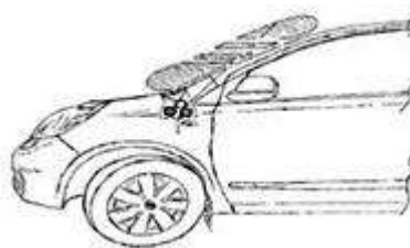
Şəkil 2. Piyada hava yastığının quruluşunun təsviri
